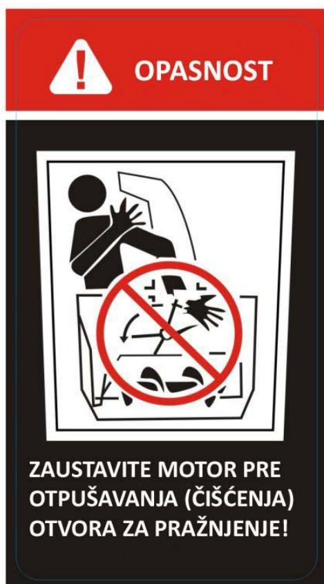
Nalepnica u vezi opsanosti kanala (tunela) za pražnjenje
